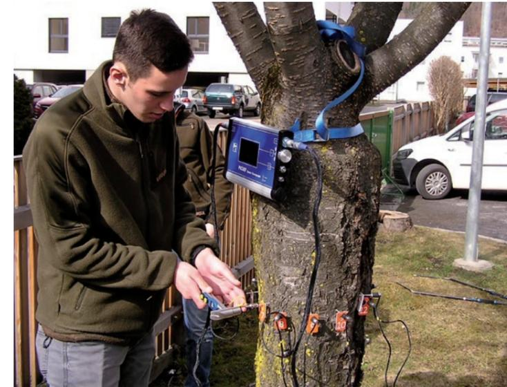
Hochempfindliche Geräte wie der Schalltomograph erlauben einen zerstörungsfreien „Blick in das Innere“ des Stammes.
