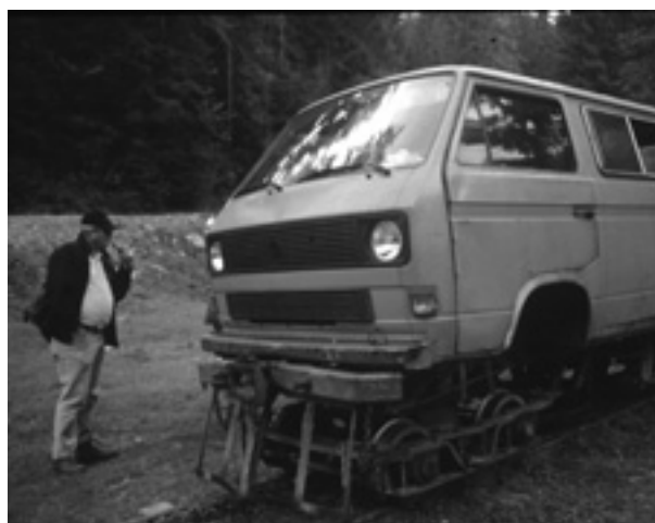
Waldbahn Wassertal Bus auf Fahrgestell für die Schiene
